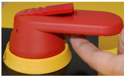
Abb. 66: Sicherungsbügel am Lasttrennschalter
